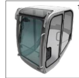
Geschlossene Frontscheibe – die zwei Glasscheiben schließen wasser- und winddicht ab.
